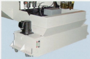
冷却剂装置（水槽部分）
