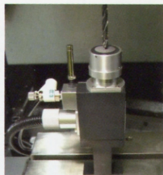
刀具长度测量器 (用于刀具长度测量及损坏检测)
