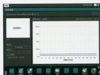
绝缘劣化检测功能画面
