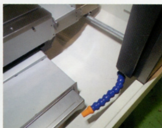
帶有机身内部清洗器的 冷却剂装置（附带油枪）
